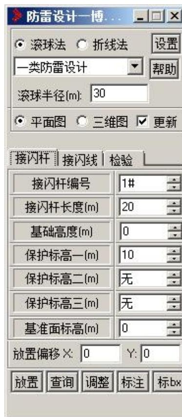
防雷设计模块是根据“滚球法”和“折线法”两种计算方法编制的。
