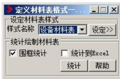
点【统计】钮，软件自动统计当前图纸上的材料，步骤如下：
