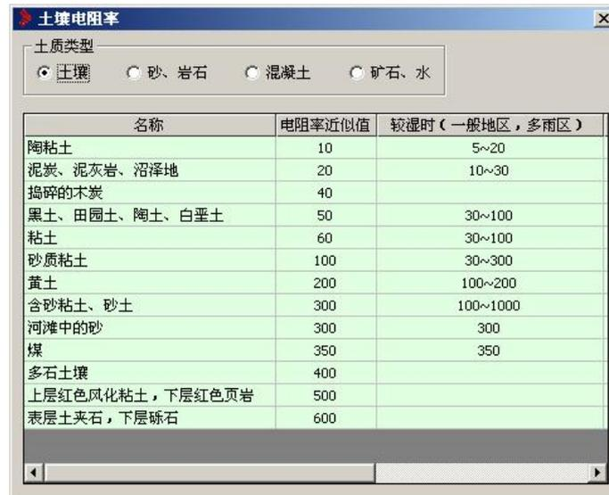
确定相应【土质类型】后，可在相关【名称】栏内点击土壤名称，则将相关土壤电阻率提出。
