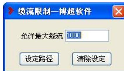
**设定路径**：把已经定义的允许最大缆流赋值给选中的桥架、电缆沟或电缆。
