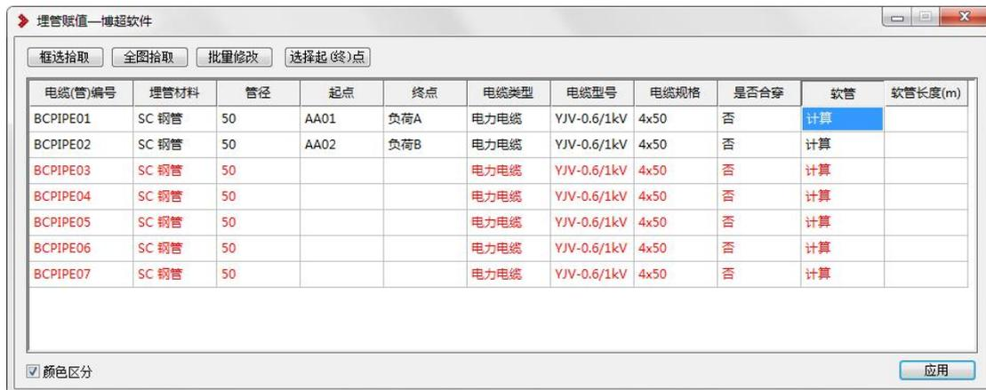
【框选拾取】：框选图面中的埋管，将埋管信息拾取到界面中；
