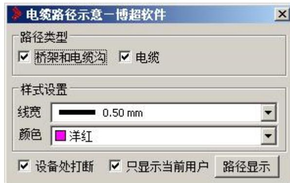
在界面中可设置是否生成桥架与电缆沟的路径、布线时的路径及线宽与颜色，需要敷设完电缆后才可使用。
