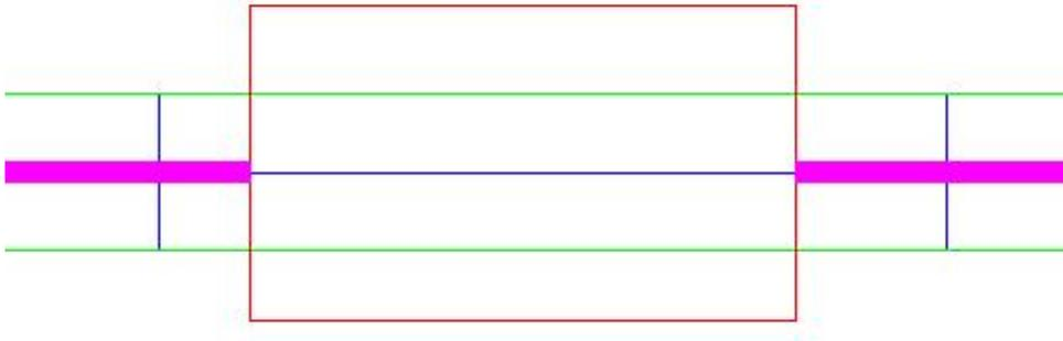
此时可通过勾选“设备处打断”使电缆路径线断开。
