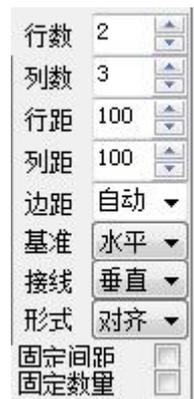
选择“垂直”：即所有矩阵布置的设备垂直接线。
