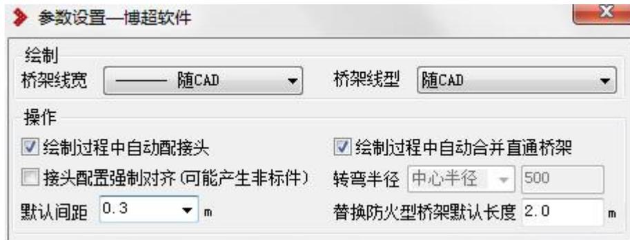
在这个功能界面中设定桥架绘制参数，线宽、线型，是否在绘制桥架的同时将每段桥架之间的分隔线绘制出来，是否自动在桥架交叉、拐角的地方绘制接头，是否自动合并直通桥架，是否接头配置时强制对其，同时设定默认的多层桥架间的层间距以及替换防火型桥架的默认长度。
