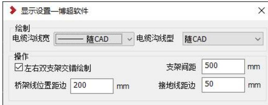
“电缆沟线宽”：设置电缆沟绘制线宽
