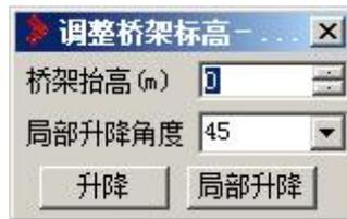
【升降】：选择需要升降的桥架，则桥架按照界面上设置的抬高高度调整桥架的标高。
