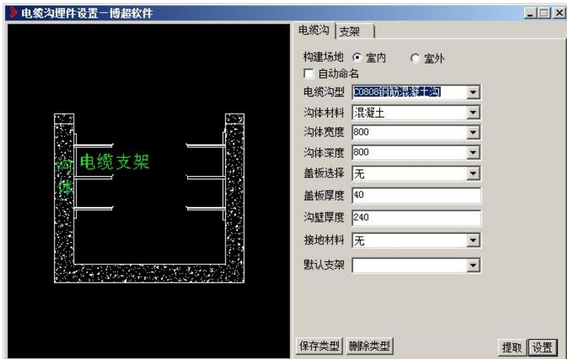
“构建场地”：设置电缆沟是用于室内，还是室外。根据构建场地自动选择电缆沟的剖面样式。
