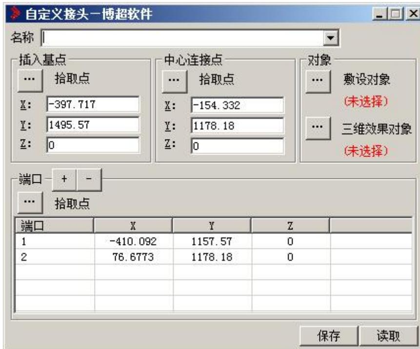
此处用于接头样式的新增，选择 CAD 的二维图形为敷设对象增加平面接头样式，选择 CAD 三维模型为效果对象增加三维接头样式，添加接头名称保存即可。
