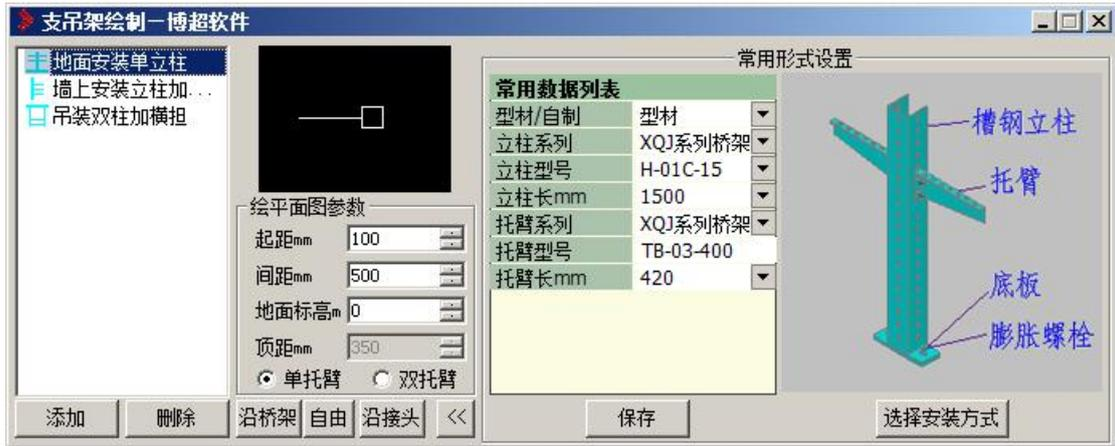
在这个功能界面中，可以设定支架托臂、立柱的类型和型号等参数进行支吊架的绘制。
