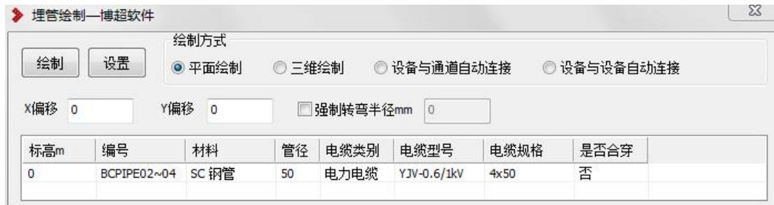
【平面绘制】：在平面视图中绘制埋管；可通过命令行提示：指定下一点或 [ 垂直模式 (V)/ 倾斜模式 (S)]；输入 v 或 s，并输入距离后，可进行垂直埋管或倾斜埋管的绘制；
