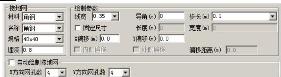
**【材料】：**选择接地线的材料。
