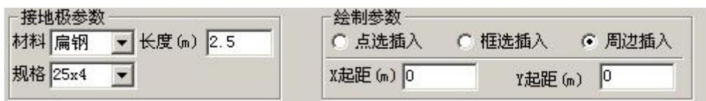
设定接地极的【材料】、【规格】及【长度】。
