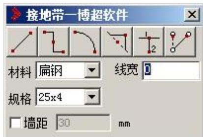
接地线的绘制与接闪带的绘制操作基本相同，请参见本手册相关章节。
