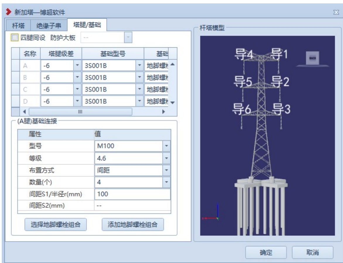
图 7.2- 26 新加塔-塔腿/基础
