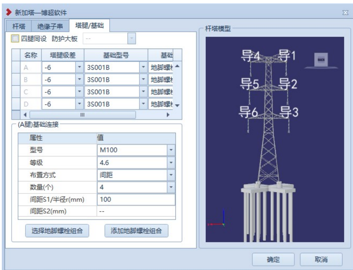
图 7.2- 27 新加塔-塔腿/基础-地脚螺栓
