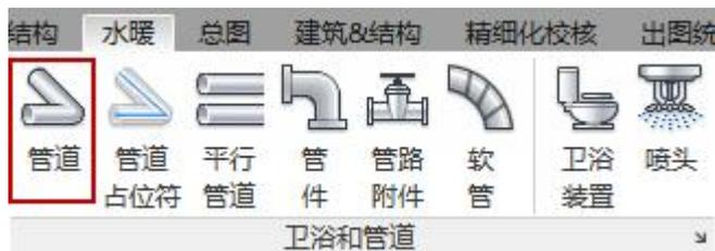
绘制时，基于水平面进行绘制，绘制高度需要修改偏移量；当想直接生成立管时，可以点击图面上一点，修改偏移量，在点击应用，就会直接生成立管；
