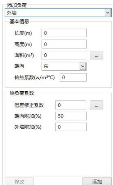
下拉可以选择对应的维护结构名称，每个维护结构对应的相关属性参数；
