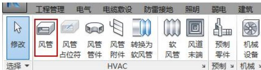
绘制时，基于水平面进行绘制，绘制高度需要修改偏移量；风管宽、高需要在数据扩充；
