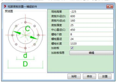
【场地高差】: 顶面距离 0m 平面的距离,可输入正负值。
