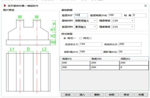
在平面视图进行布置,支持参数化调整模型,基础与垫层可以设置材料和强度等级,布置后自动计算工程量;
