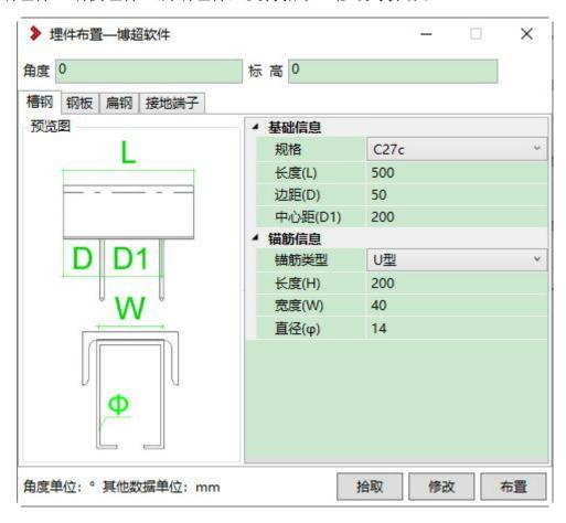
【锚筋类型】: 八字型、U字型、J字型3种,不同类型对应不同参数。
