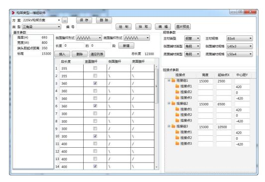
【方案】内置 110kV、220 kV、格构式 3 种方案,引用方案时,带有默认构架梁、柱的相关参数,可以直接使用,参数不对时,可以进行修改或创建新的样式;
