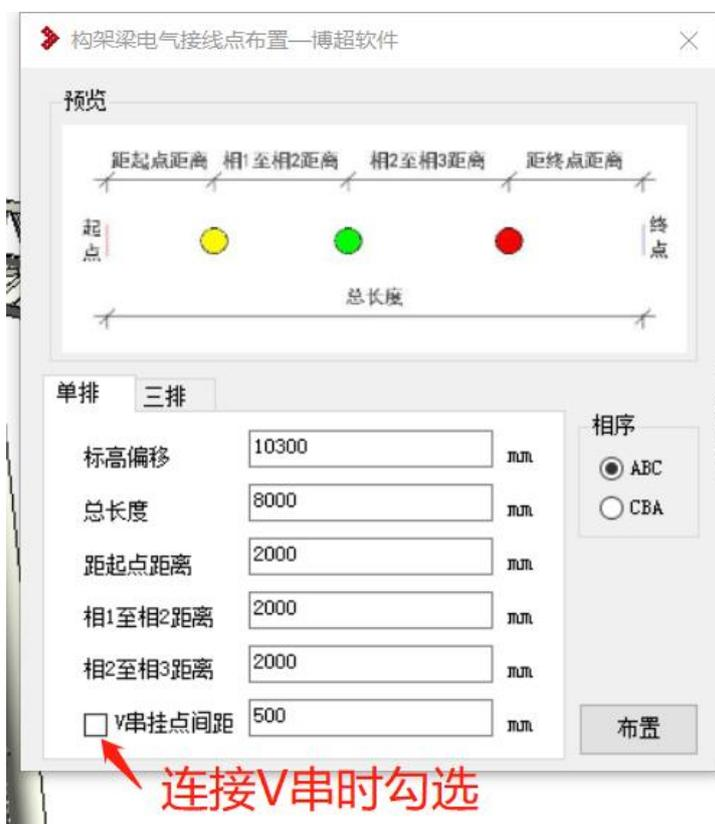
3) 电气专业可使用协同设计-【提资构架梁】功能，进行简易梁布置。V串绘制需要选择“6挂点”。
