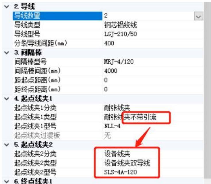
f) 跨线连接需要用到绝缘子串，要提前进行工程库的选型。
